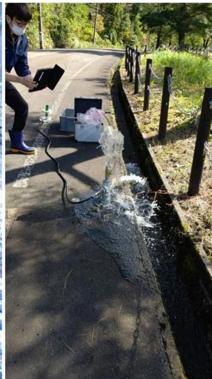
写真1 森林フィールド 樹木の根の分布動態調査のための掘削試験
