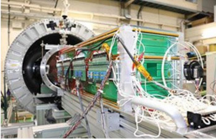
図1：中性子寿命測定実験用のガス検出器と超伝導磁石
