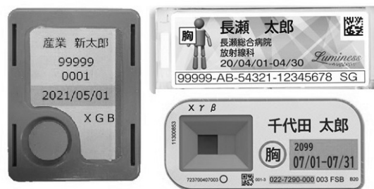
図2 国内で使用されている受動形の被ばく線量計（左：産業テック(株)，右上：長瀬ランダウア(株)，右下：(株)千代田テクノル。「受動形」線量計はその場で線量を確認できないタイプのものです。）
