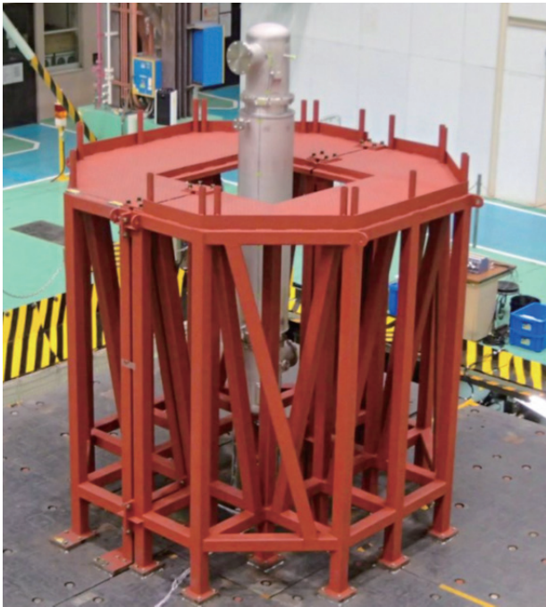
図2 3次元加振台の上に設置されたスクラバー塔 中央のステンレス製の銀色の筒がスクラバー塔
