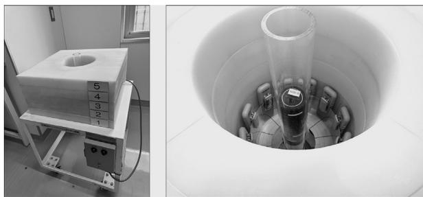
写真2 ポケット線量計用治具
