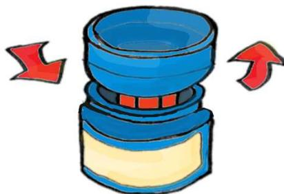
(3)八角レンチを反時計回りに回してキャップを外します。
