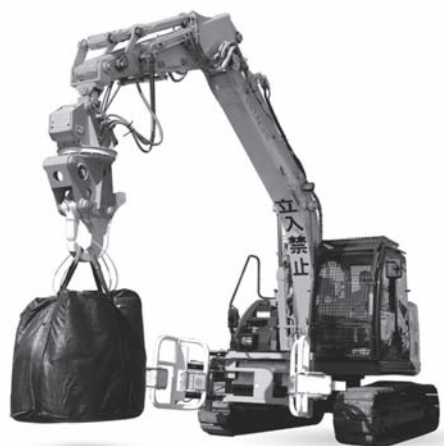
写真1 放射能計測駆動装置 SiKi® 付放射性汚染廃棄物土のう袋用小型移動式クレーン仕様機 (ZAXIS ZX135US-5B)
